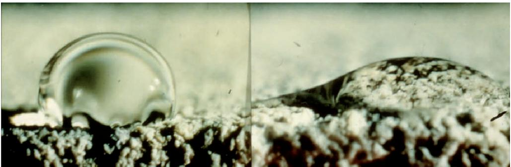
Abb. 7: Geändertes Benetzungsverhalten eines Baustoffes ohne (links) und mit Biofilm (rechts)
